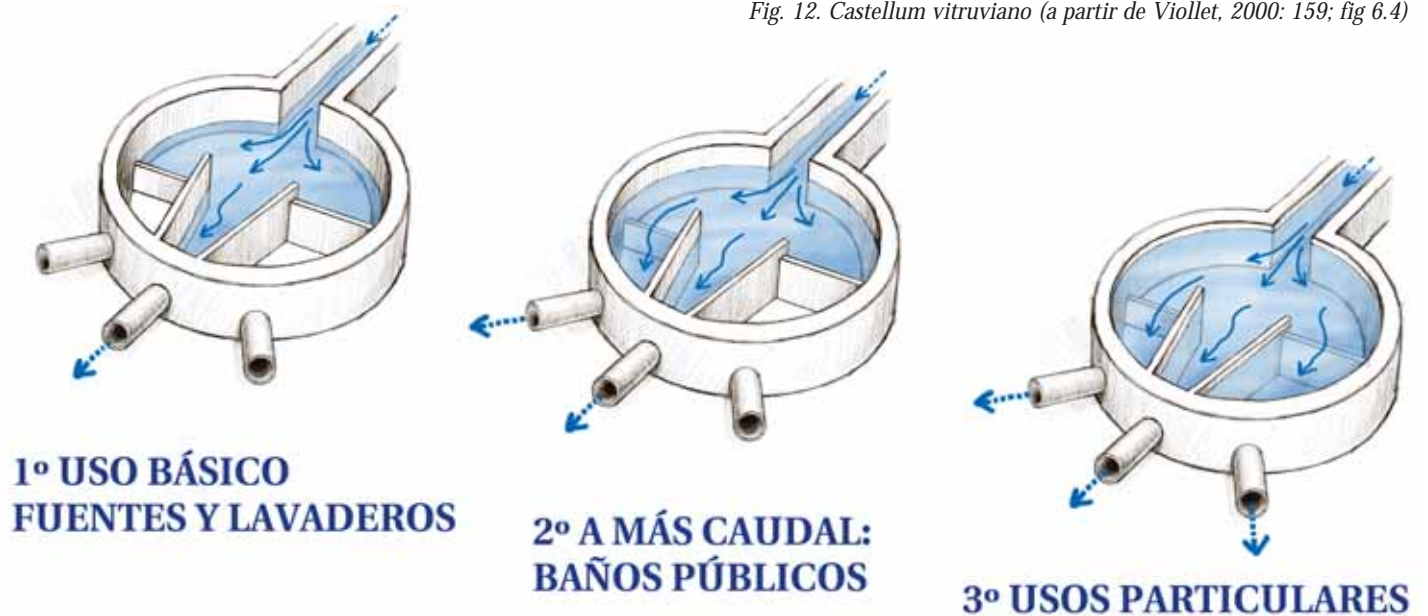
Fig. 12. Castellum vitruviano (a partir de Viollet, 2000: 159; fig 6.4)
